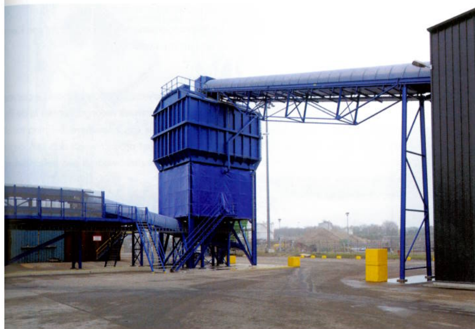
Afb. 3 De voorraadbunker is voorzien van een weeginstallatie om de continu aangevoerde materiaalstroom batchgewijs te wegen
